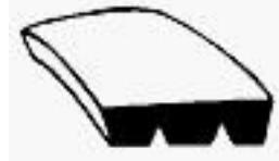
Una cinghia striata è rappresentata da una cinghia senza fine con superficie di trazione striata in senso longitudinale (e talvolta trasversale) che provoca, tramite sfregamento, la messa in azione di pulegge corrispondenti.
