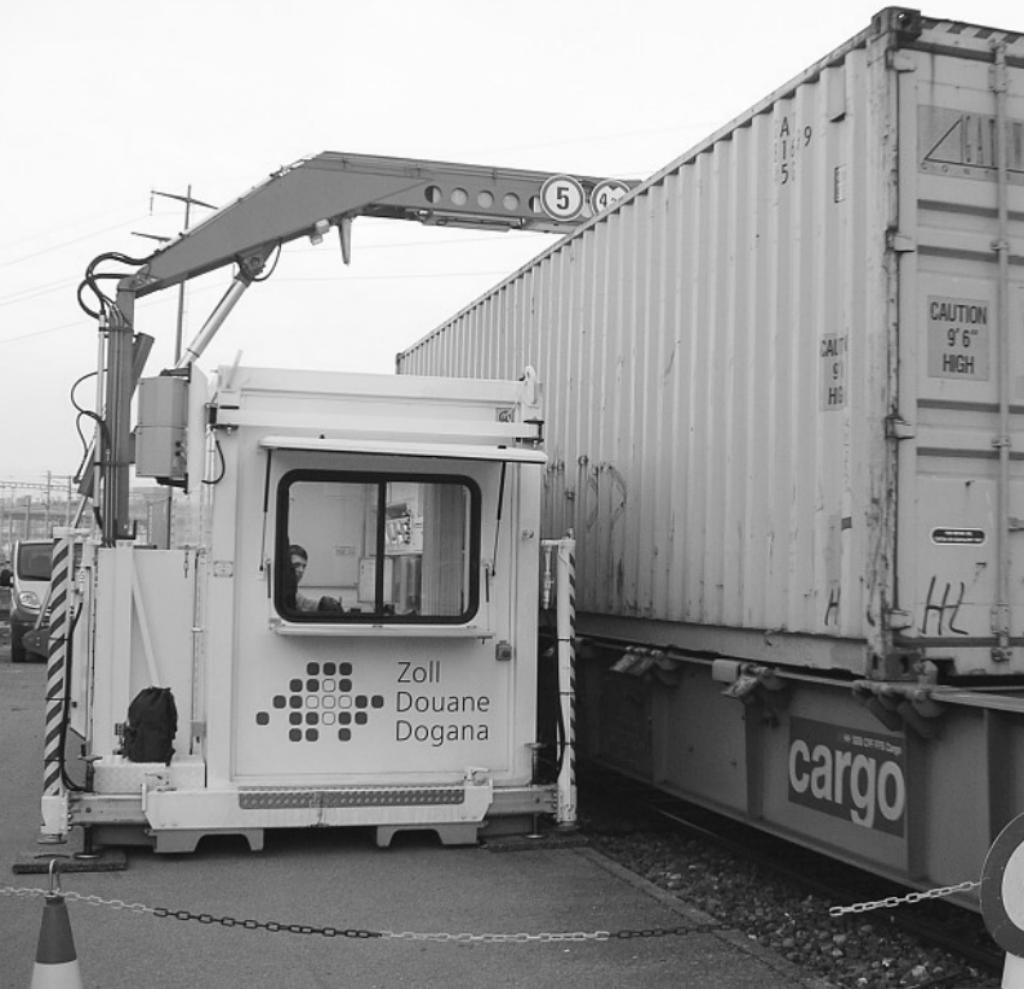
Grazie ai due scanner mobili, la dogana può controllare in modo più efficiente i carichi degli autocarri e quindi ridurre i tempi di attesa al confine. Gli scanner vengono altresì utilizzati nella zona di confine per i controlli combinati di polizia e doganali nel traffico pesante. Dall'estate del 2006 è possibile controllare ai raggi X anche i vagoni ferroviari e i container.
