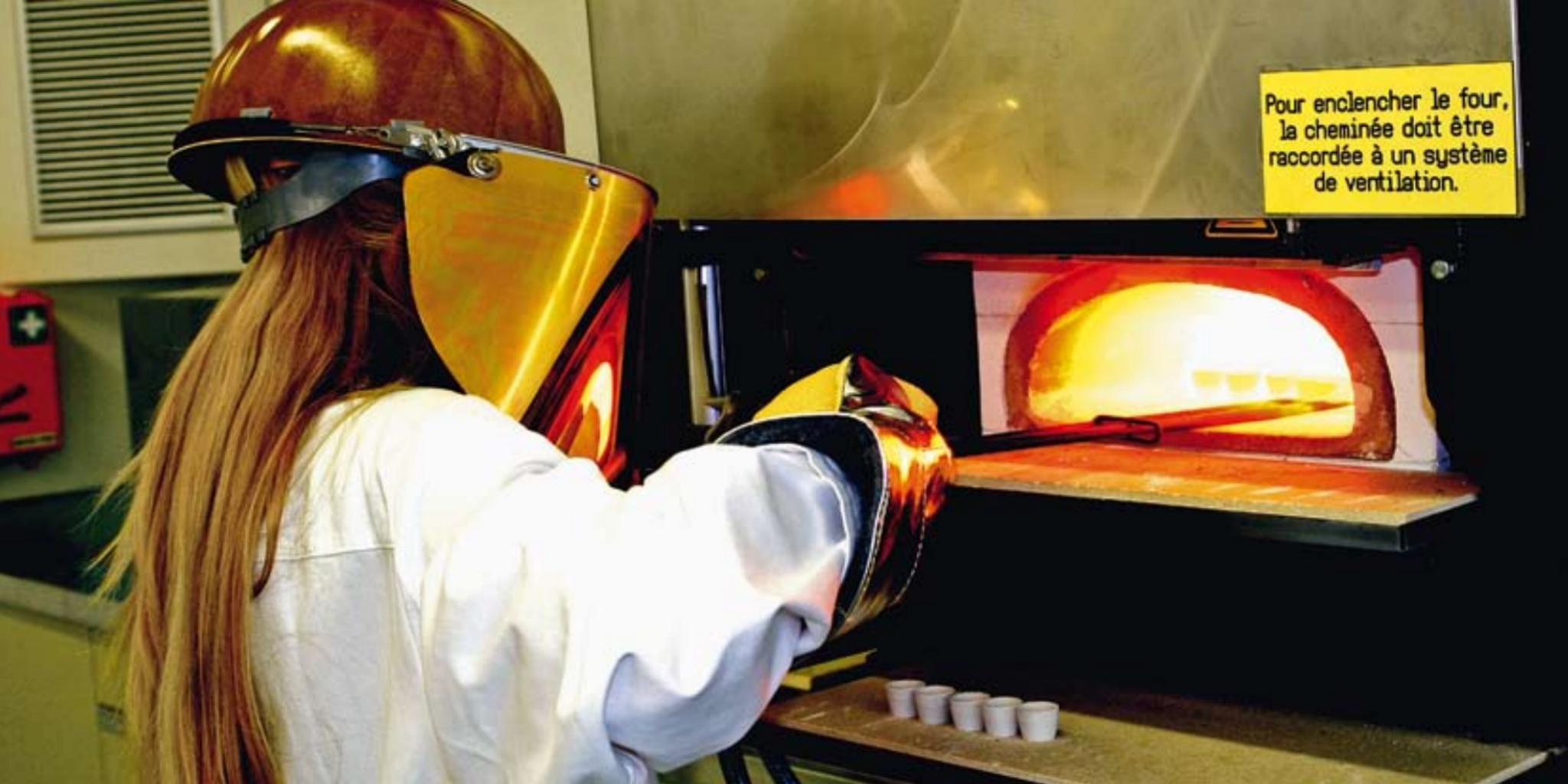
Pour enclencher le four, la cheminée doit être raccordée à un système de ventilation.
