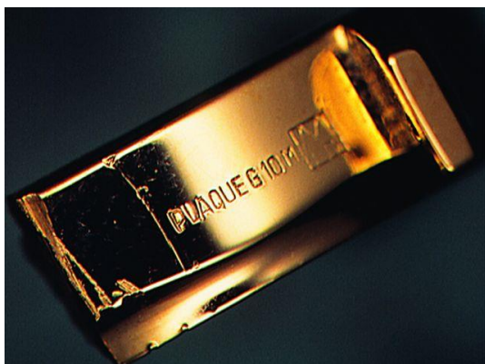
Marquage d'un ouvrage plaqué.
