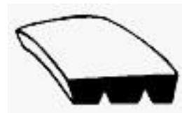
Ein gerillter Treibriemen ist ein endloser Riemen mit in der Längsrichtung gerillter Antriebsfläche, der durch Friktion eine entsprechend geformte Riemenscheibe antreibt. Die gerillten Treibriemen sind eine Art von trapezförmigen Treibriemen.
